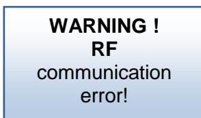
Este mensaje será enviado en el caso de la pérdida de la comunicación entre la unidad central V24 y la antena RF del módulo GSM.
