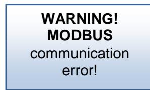
Такое сообщение отправляется, если теряется связь через шину между GSM модулем и центральным блоком V24, или связь с антенной в беспроводном варианте.
