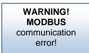
Este mensaje será enviado si se pierde la comunicación por la barra colectora entre el módulo GSM y la unidad central V24, eventualmente la comunicación con la antena en el caso de la versión sin hilos.
