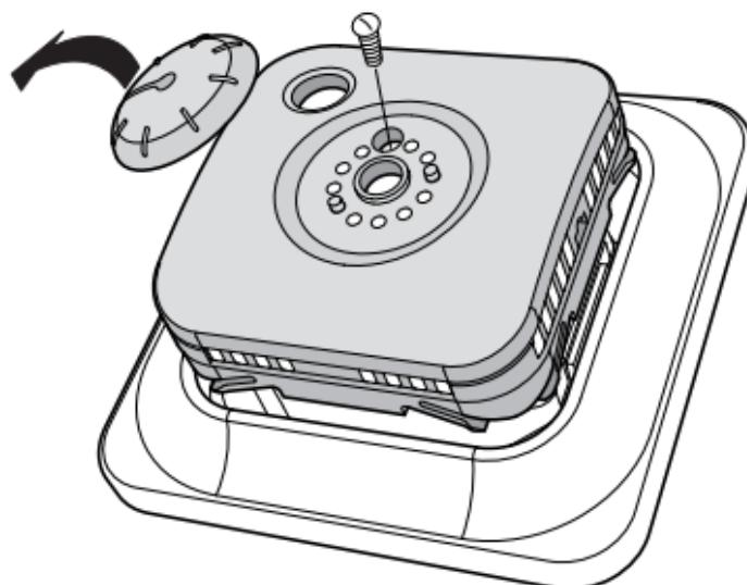
3. Schließen Sie das Stromversorgungskabel (Spannung 230 V AC), das Last- und bei Bedarf das Bodensensorkabel an.
