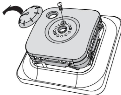
Drehen Sie dann mit einem kleinen Schraubenzieher den Regler in die gewünschte Position.
