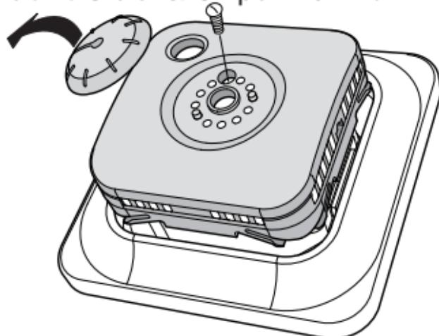
Отрегулируйте положение регулятора до желаемого значения с помощью отвертки.
