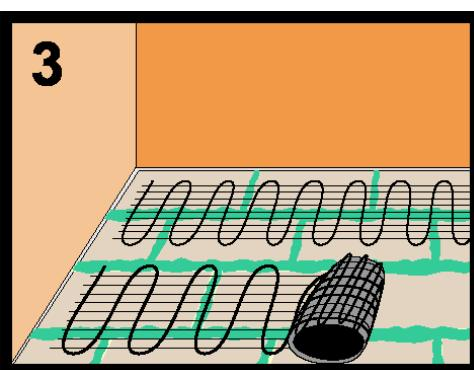
Spáry se upravují výstužnou perlinkovou páskou. Položte pásku, naneste lepicí hmotu Beta Form H01, přebytek hmoty roztahněte hladítkem, popřípadě odstraňte. Přesah pásky musí být min. 50mm. Desky není dálé nutné hydroizolovat. Lepicí hmotu nechte vytvrdnout dle návodu k použití.
