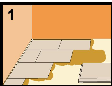
Rozneste zubovou stěrkou lepicí tmel na cementové bázi. Desky pokládejte dle obrázku 1, důkladně usaďte a vyrovnejte. Lepicí hmotu nechte vytvrdnout dle návodu k použití. Při pokládce nesmí lepicí hmota pronikat do spár mezi deskami. Dilatační spáry v podkladu musí být zachovány.
