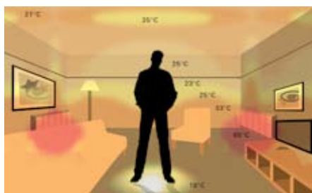
Rozložení teplot při použití konvenčního topného systému s radiátory. Velké rozdíly teplot v místnosti (18 - 65°C).
